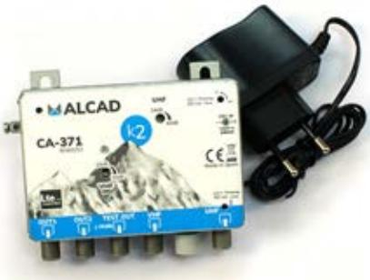
Amplificador de banda ancha para cabecera con tres entradas y dos salidas. Tiene dos entradas UHF con filtro de rechazo para LTE700 y otra entrada para BI/FM/BIII/DAB. Las dos salidas del amplificador tienen el mismo nivel de salida, con un máximo de 110 dB $\mu$ V, y facilitan hacer distribuciones en estrella utilizando distribuidores.
