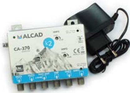
Amplificador de banda ancha para cabecera con tres entradas y dos salidas. Tiene dos entradas UHF con filtro de rechazo para LTE700 y otra entrada para BI/FM/BIII/DAB. Las dos salidas del amplificador tienen el mismo nivel de salida, con un máximo de 110 dB $\mu$ V, y facilitan hacer distribuciones en estrella utilizando distribuidores.
