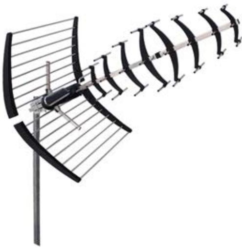
Antena con la mejor recepción de los canales TDT y con la mayor ganancia del mercado (18 dBi). Diseñada para cubrir la banda de UHF hasta 694 MHz. Rechazo de las señales de telefonía 4G y 5G gracias a su simetrizador con filtro de rechazo LTE700 incorporado. De fácil montaje y ajuste, garantiza la máxima robustez y la mayor seguridad durante la instalación. Atractivo diseño que refleja a la perfección las excelentes cualidades eléctricas y mecánicas de la antena.
