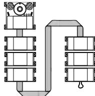
Détail: raccordement des compartiments de bouton-poussoir
