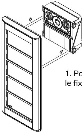
1. Positionnez le module principal et appuyez pour le fixer au châssis.
