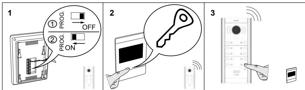
**Nota:** Una vez programado el monitor, asegúrese de que el interruptor PROG queda en posición ON.
