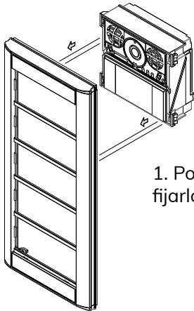
1. Posicione el módulo principal y presione para fijarlo al bastidor.
