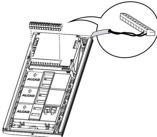
4. Une fois les branchements terminé, configurez les plaques d'entrée. Voir configuration du switch arrière SW1, page 101.
