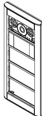
**REMARQUE :** Utilisez les deux mains pour retirer la vitre avant : maintenez l'outil de retrait avec votre pouce et votre index et tirez doucement tout en posant vos mains sur le mur pour mieux contrôler le mouvement. Pour l'extraction de la vitre frontale de 2 fenêtres il est préférable de fixer l'outil en partie basse de la vitre.
