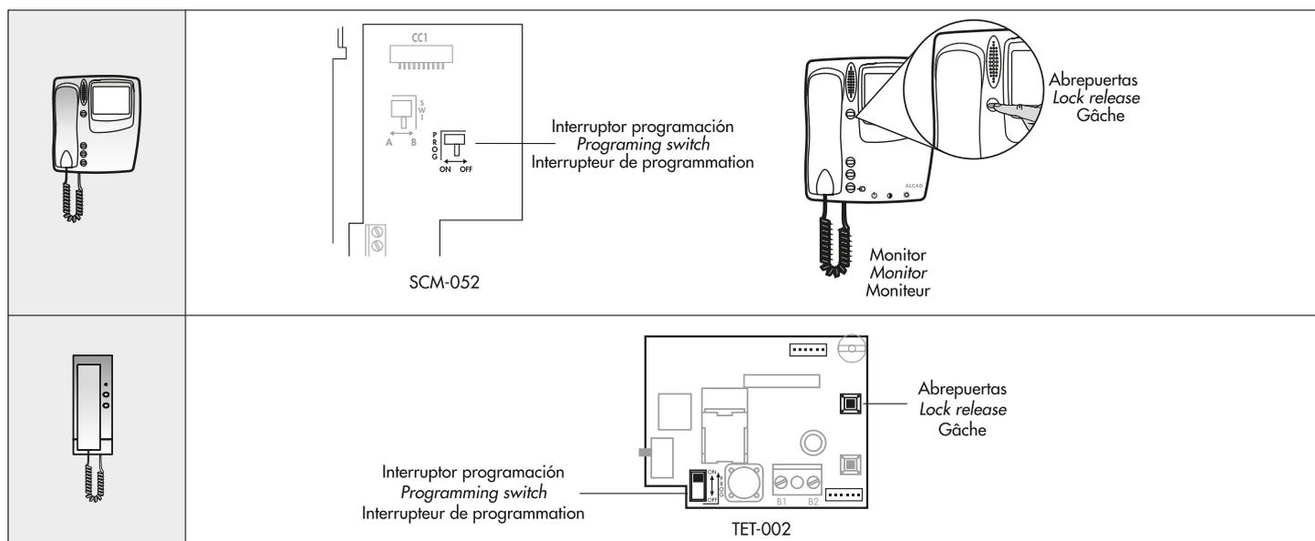
La programación de un soporte de conexiones/telefono debe realizarse desde la placa de calle principal del sistema (Vea "instrucciones de configuración de la placa de calle con teclado", página 19).
