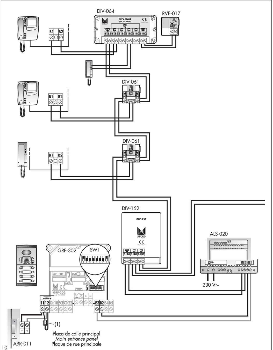
**INSTALACIÓN BÁSICA CON DISTRIBUIDOR. 2 COLUMNAS**
