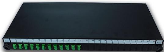
Plateau de distribution 1U pour armoires 19". Jusqu'à 24 fibres: 12 ports simplex SC / APC monomodes sont préinstallés et 12 ports supplémentaires peuvent être installés (non inclus). 4 points d'entrée de câble. Fabriqué en acier laminé à froid. Plaque arrière amovible.
