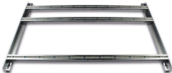
Cadre de support pour les têtes de réseau de la série 912 avec alimentation redondante. Il peut contenir jusqu'à 2 alimentations, un amplificateur et 7 modules, ou 2 alimentations et 8 modules. Il y a une distance de 47 mm entre les modules pour permettre une meilleure dissipation de la chaleur.
