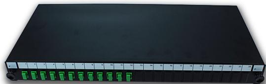
Bandeja de distribución de 1U para racks de 19". Hasta 24 fibras: se incluyen 12 puertos simplex SC/APC monomodo y se puede instalar otros 12 puertos (no incluidos). 4 puntos de entrada de cable. Fabricada en acero laminado en frío. Placa trasera extraíble.
